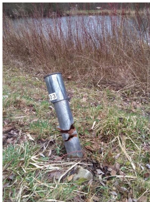
Figuur 4.2 Rijschade aan robuuste beschermkoker op afgesloten terrein en maaischade
